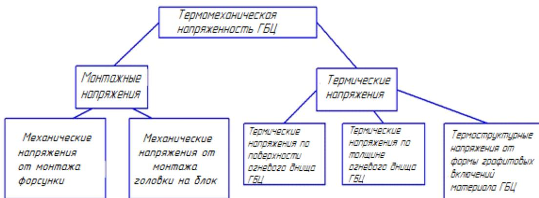
Рис. 1. Термомеханическая напряженность огневого днища головки блока цилиндров дизеля
