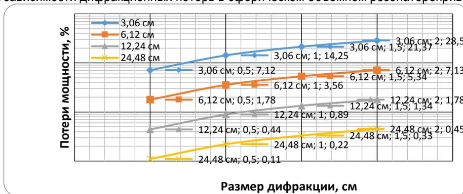
Рис. 1. Зависимость потери мощности от расстояния между полусферами при разных радиусах сферы – 3,06 см; 6,12 см; 12,24 см; 24,48 см
