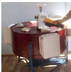
Рис. 1. Многорезонаторная СВЧ установка для вытопки жира
