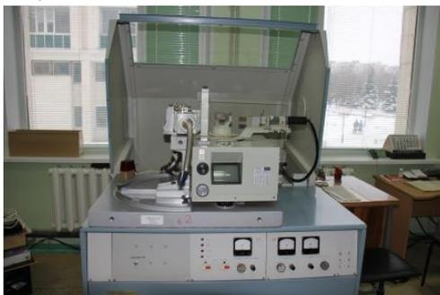
Рис. 1. Дифрактометр рентгеновский ДРОН-3М
