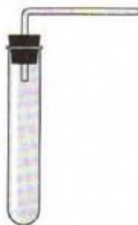
Рис. 9. Прибор для получения газов
