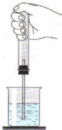
Рис. 11. Проверка на герметичность прибора для получения газов
