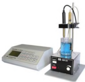
Рис. 24. Устройство для проведения потенциометрических измерений
