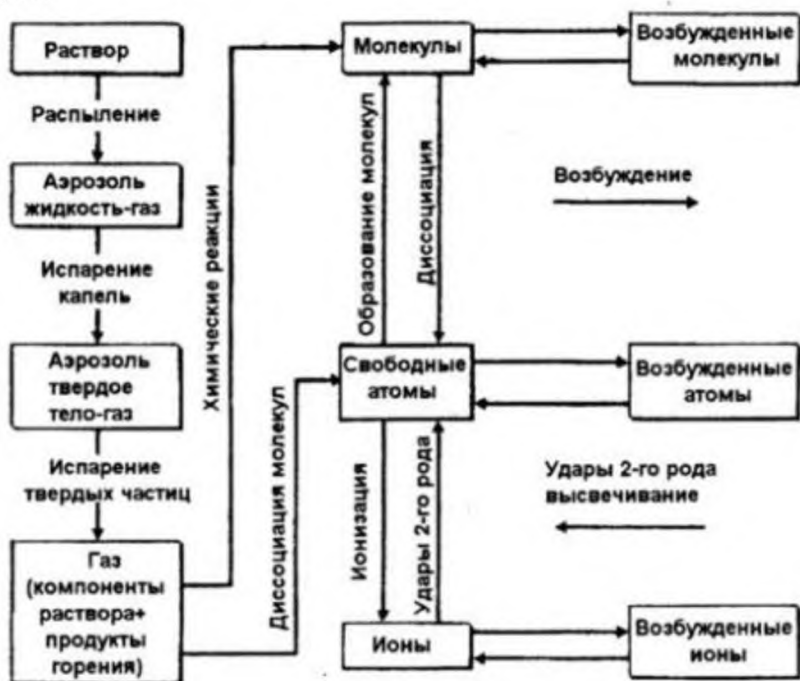
Рис. 17. Схема процессов, происходящих в пламени
