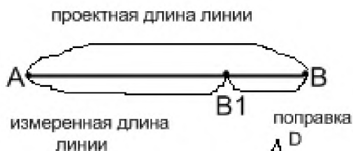
Рис. 9. Вынос в натуру прямой горизонтальной линии
