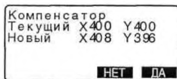
Рис. 18. Новые значения поправок после юстировки
