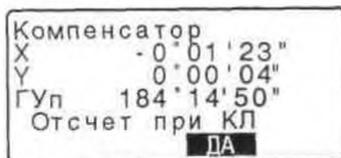
Рис. 17. Скомпенсированные угловые отсчеты по оси X и оси Y
