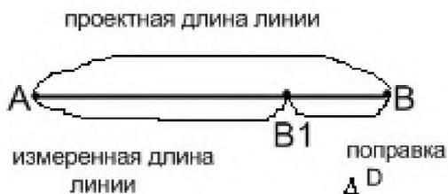
Рис. 9. Вынос в натуру прямой горизонтальной линии
