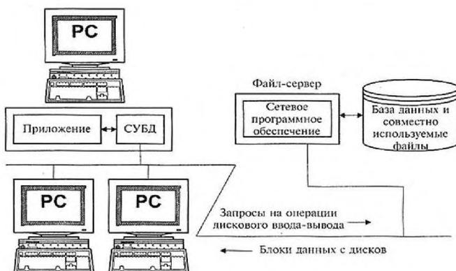
Рис. 8 Принципиальная схема работы системы «файл-сервер»
