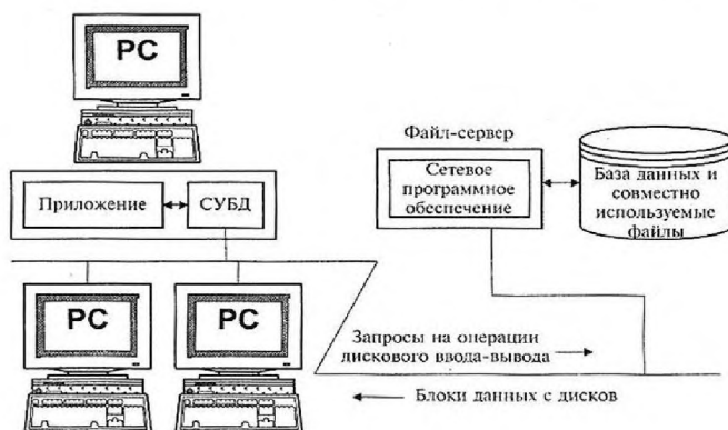
Рис. 8 Принципиальная схема работы системы «файл-сервер»
