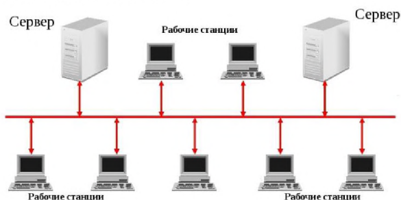
Рис. 6. Сеть с выделенным сервером
