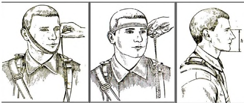
Рис. 6.4. Схема измерения лица при подборе СИЗОД: для противогаза и для респиратора
