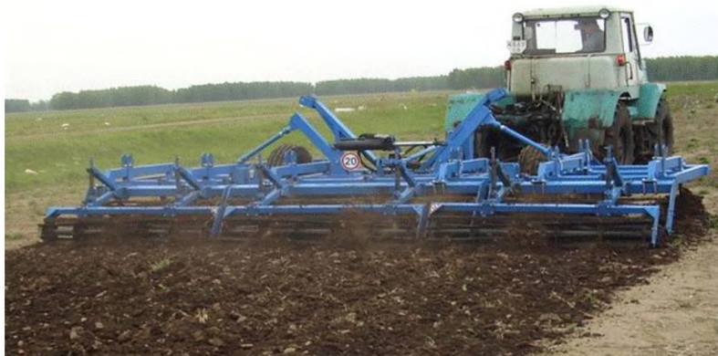
Рис. П. 2.4. Культиватор «Степняк-7,4» (ФГУП Омский экспериментальный завод, г. Омск)
