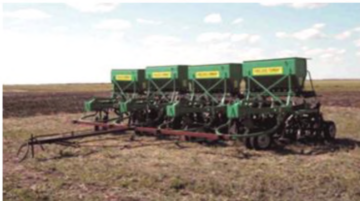
Рис. П. 2.13. Посевной агрегат из четырех сеялок-культиваторов СКС-210 «Омка» (ООО «Омскагроптехсервис», г. Омск)
