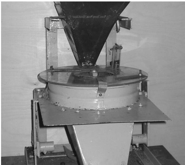
Рис. 10.11. Общий вид высеваящего аппарата непрерывного дозирования гравитационного действия
