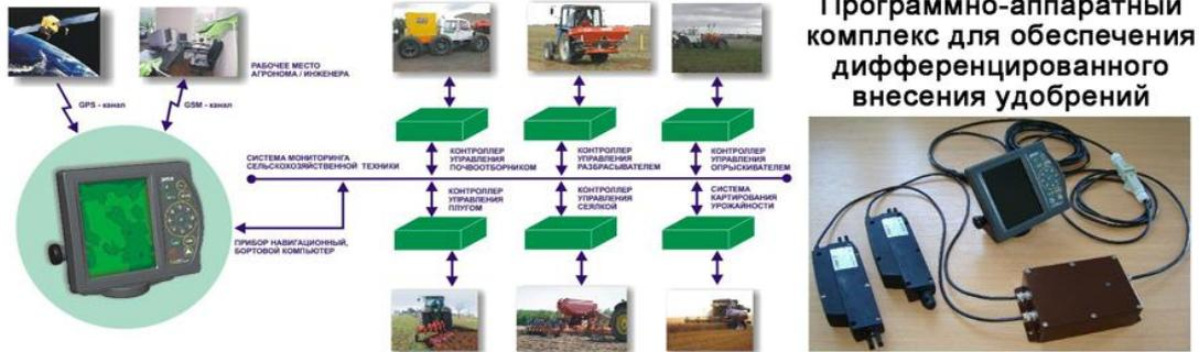
Программно-аппаратный комплекс для обеспечения дифференцированного внесения удобрений
