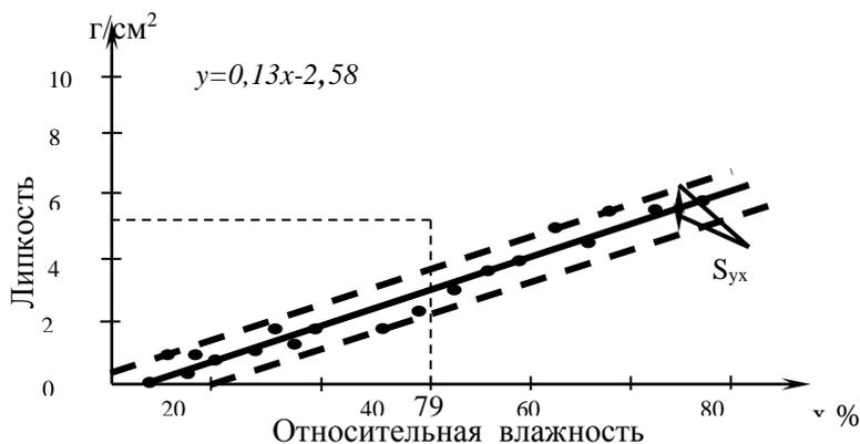
Рис. 7. Точечный график и теоретическая линия регрессии при прямой корреляции между липкостью и относительной влажностью почвы
