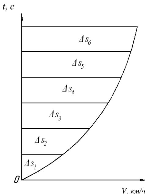
Рис. 5.6. График зависимости времени разгона автомобиля от скорости
