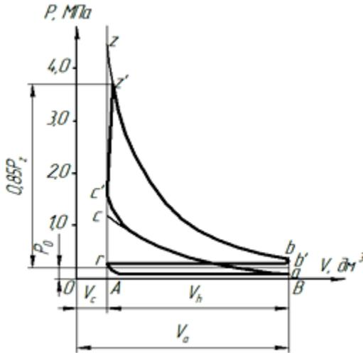
Рис. 4.1. Индикаторная диаграмма четырехтактного двигателя с искровым зажиганием
