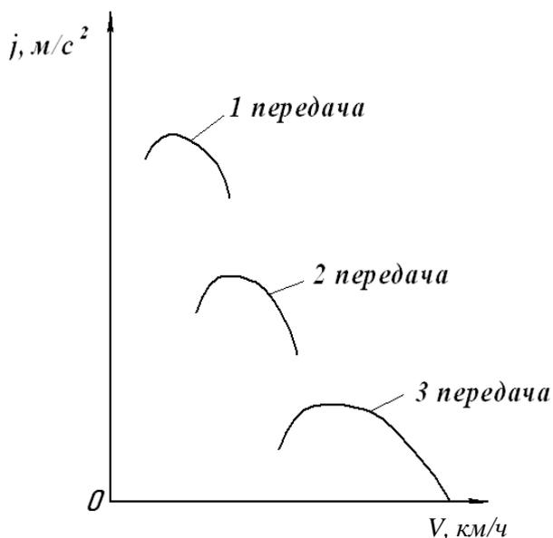
Рис. 5.4. Графики зависимости ускорения автомобиля от скорости
