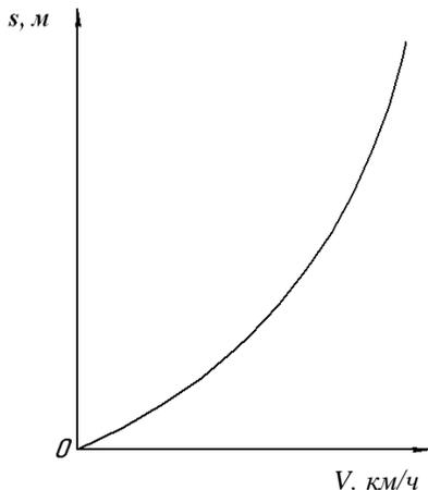
Рис. 5.7. График зависимости пути разгона автомобиля от скорости
